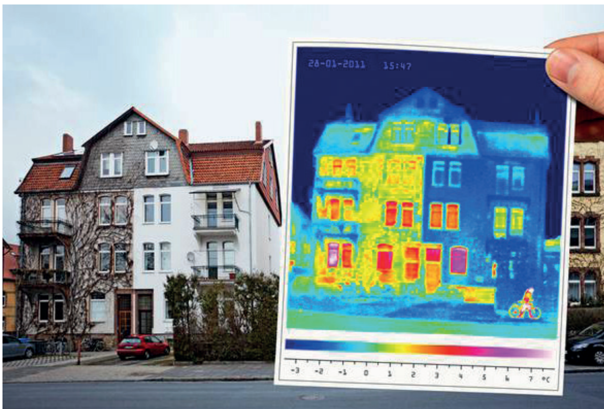
Abbildung: Wärmebild einer gedämmten und ungedämmten Haushalthälfte ( https://www.energiesparen-im-haushalt.de/energie/bauen-und-modernisieren/modernisierung-haus/nachtraegliche-waermedaemmung.html )
